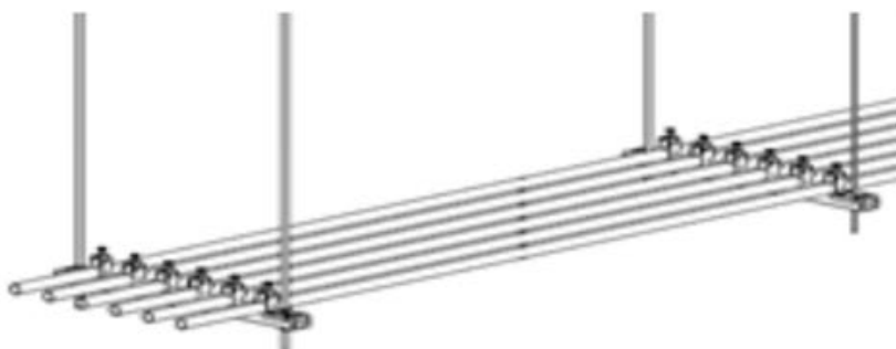
Рисунок 15 - Многорядная прокладка ОКЛ на подвесах к потолку
